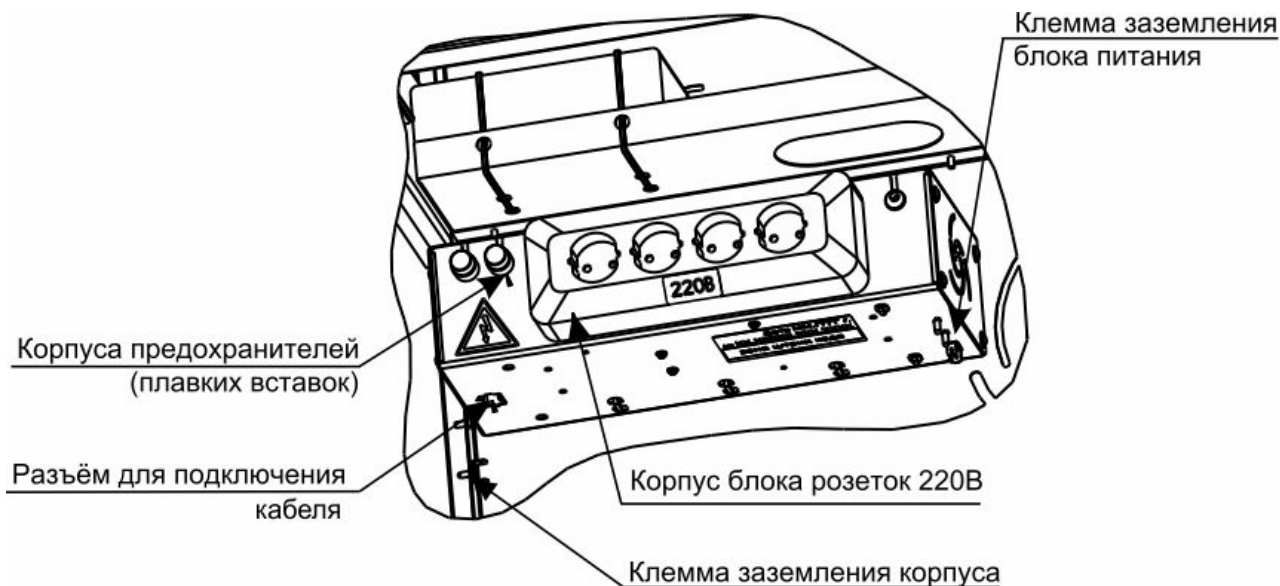
Рисунок 4.28 - Элементы корпуса блока питания
